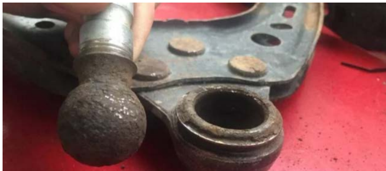
(Ржавый шаровой шарнир Тесла из инцидента в г.Коннеллсвилл)
